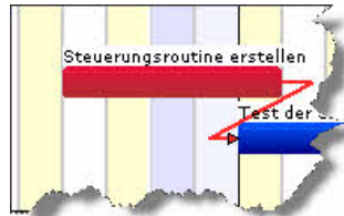
Pfeil bei Fehlplanung
